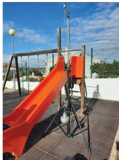
Figura 75 Realização de Ensaios HIC, (NP EN 1177 - avaliação da capacidade de amortecimento dos pisos), Critério relativo a traumatismos cranianos causados por quedas)
