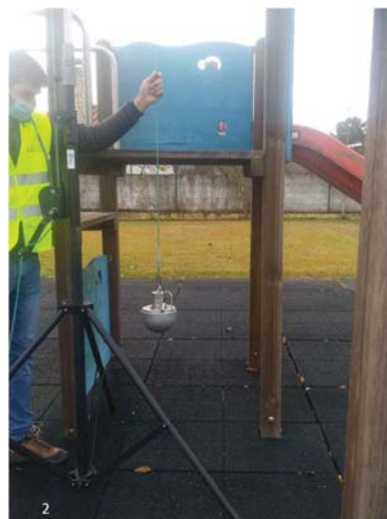
Figura 72 Realização de Ensaio HIC, (NP EN 1177 - avaliação da capacidade de amortecimento dos pisos), Critério relativo a traumatismos cranianos causados por quedas)
